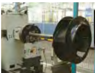
Vyvažování oběžných kol a rotorů
