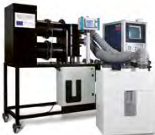
Testovací zařízení pro kontrolu parametrů malých rekuperačních jednotek, testuje se 100 % výrobků, včetně archivace dat
