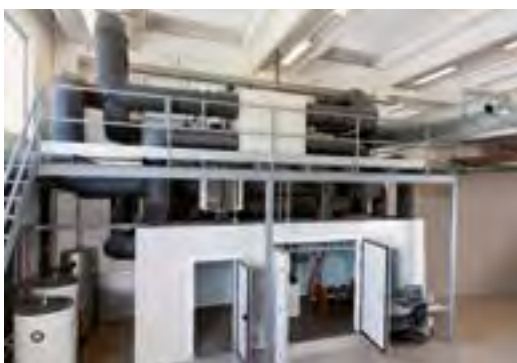
Klimatická komora pro testování rekuperačních jednotek
